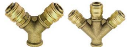
2-fach bzw. 3-fach Verteiler mit Schnellverschlusskupplungen DN 7,2 und Innengewinde Pressmessing (auch mit Außengewinde)/ 2-way resp. 3-way distribution quick- lock coupling ND 7,2 female thread pressed brass (male thread as well)
